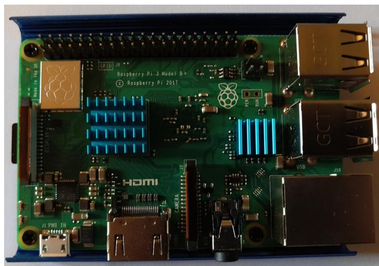
Emboîter la partie supérieure en faisant attention à l'emplacement des ports
